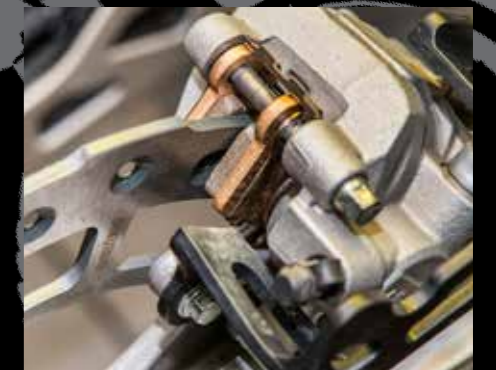
Fácil montaje de pastillas y discos y ajuste exacto que permitieron la perfecta adaptación a la Suzuki.
