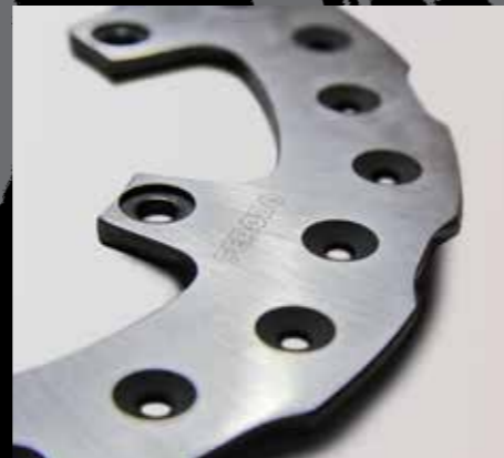
Ferodo ha denominado DES (Sistema de Eliminación de la Suciedad) al diseño de los discos de off road MXR con los agujeros en forma cónica.
